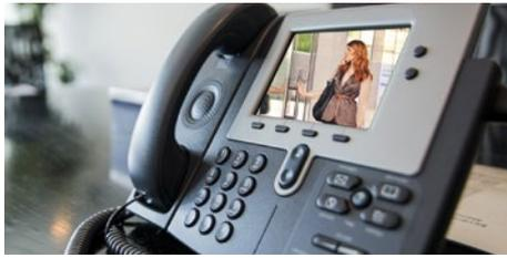
Über SIP (Session Initiation Protocol) wird auch die Einbindung in eine IP-Telefonanlage unterstützt. Wenn zum Beispiel die Türklingel mit einem kompatiblen Telefon verbunden ist, kann beim Klingeln das Livebild der Kamera auf dem Telefon eingeblendet werden.
